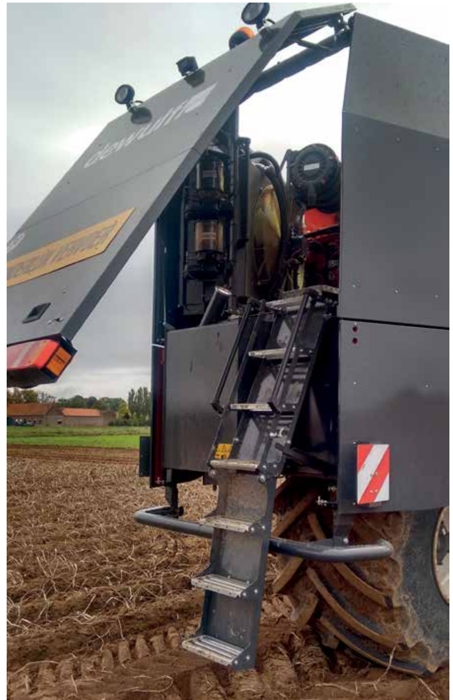
毎日のチェックポイントと燃料補給のための容易なアクセス
