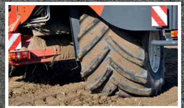
タイヤ空気圧1.4バールのオプションのスーパーワイドリアホイール (1250/50 R32)
