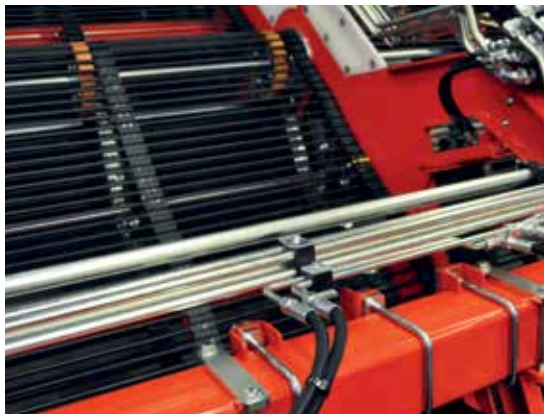
パイプを最大限使用 = ホースどうしの摩擦がない
