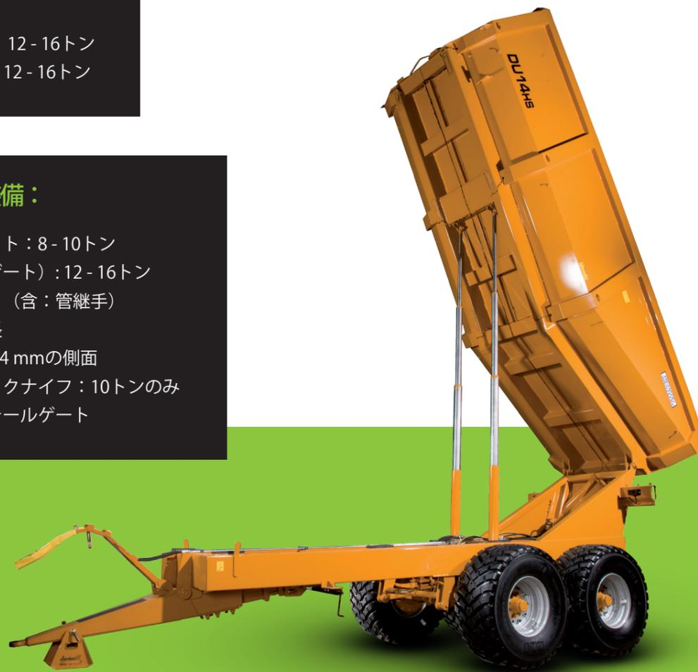
農業及び一般用途向け大容量ダンプトレーラー。8, 10, 12, 14, 16トン用モデルをご用意。Richard western社の農業ダンプトレーラーは、4 mmの床と3 mmの側面、オプションで6 mmの床と4 mmの側面を製造している。
