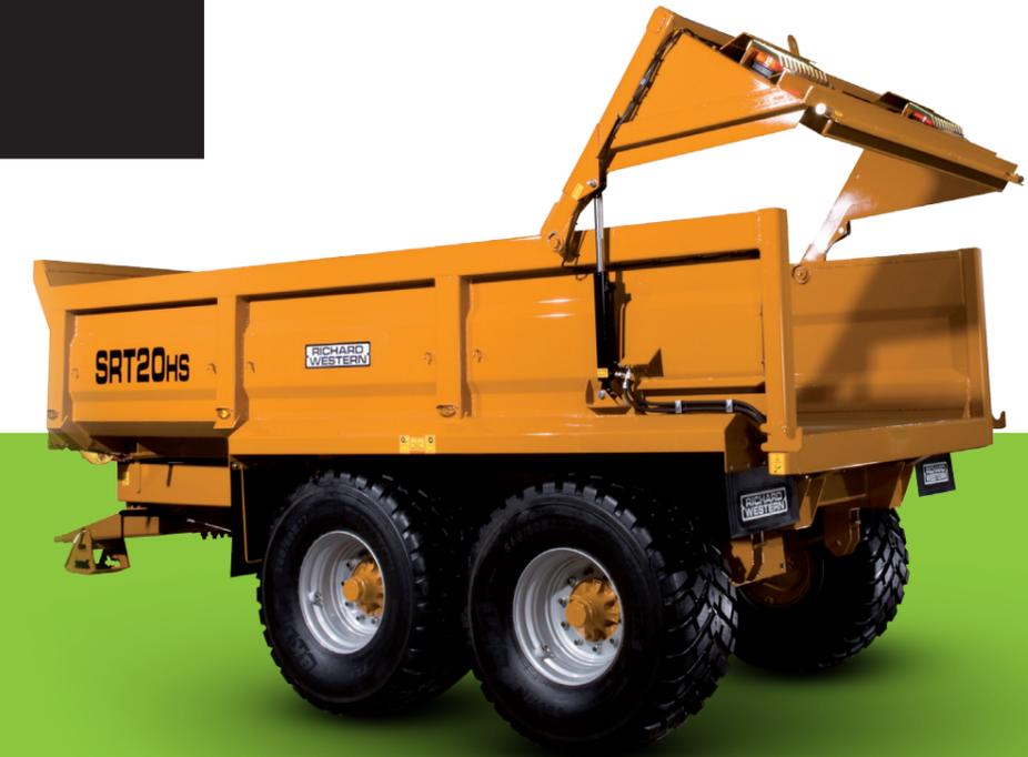
石・瓦礫トレーラーはタフな作業ができるように設計されている。20トンまたは24トンの積載量があり、リーフスプリングサスペンションで420mm x 180mmブレーキを備えた商用車軸が装備されている。テーパモノコックボディには、6 mmのサイドパネルと8 mmの床があり、8~15立方メートルのサイズで利用できる。3段のダンプシリンダーを装備しているため、足場の悪い土地での安定性が向上する。標準装備には、スプリングドロワーと油圧式テールゲートが含まれている。
