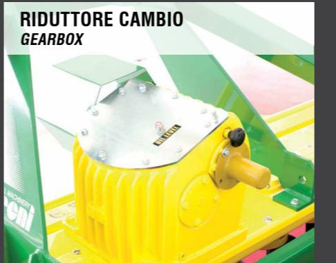
Il **riduttore** in ghisa con nervature di raffreddamento garantisce ottima robustezza e dispersione del calore. Il cambio a leva modula la velocità dei rotori in base alle condizioni, ottimizzando il lavoro in terreni difficili e risparmiando carburante ed usura in terreni leggeri. Il riduttore progettato ad altezza maggiorata riduce l'inclinazione dell'albero cardanico abbattendo usura e vibrazioni.
