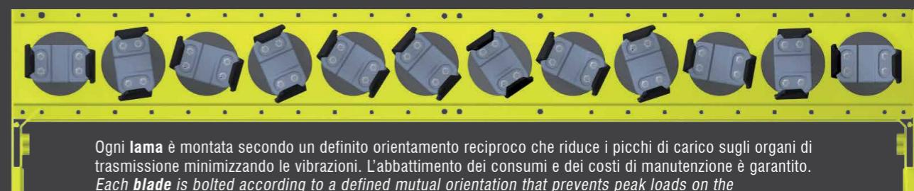
Ogni **lama** è montata secondo un definito orientamento reciproco che riduce i picchi di carico sugli organi di trasmissione minimizzando le vibrazioni. L'abbattimento dei consumi e dei costi di manutenzione è garantito. *Each **blade** is bolted according to a defined mutual orientation that prevents peak loads on the transmission. The savings are guaranteed in terms of both consumption and prevention of damage.*
